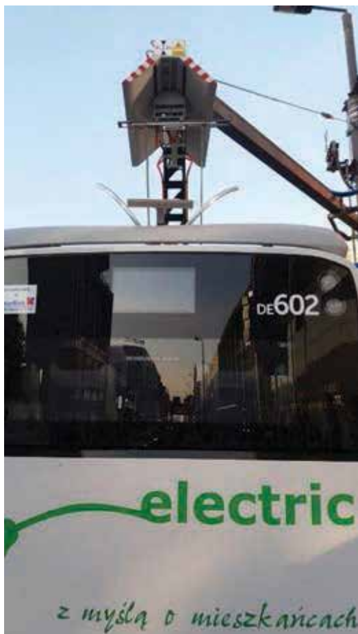
Fot. 5-6. Widok od strony tyłu pojazdu na przyłączy do ładowania zasobnika autobusu.
