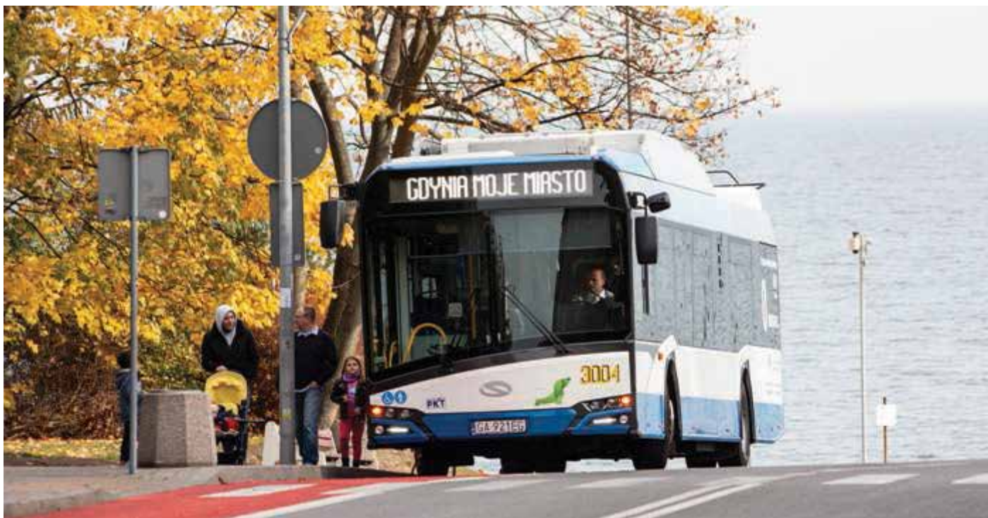
Fot. 1. Trolejbus PKT w Gdyni – Solaris Trollino z dodatkowymi bateriami litowo-jonowymi.
