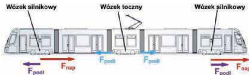
Rys. 12. Zasada „rozciągania pojazdu” dla wspierania centrowania wózka tocznego na przykładzie pojazdu Avenio M.
