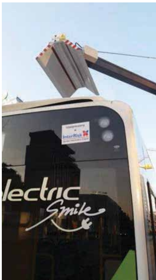
Fot. 5-6. Widok od strony tyłu pojazdu na przyłączy do ładowania zasobnika autobusu.
